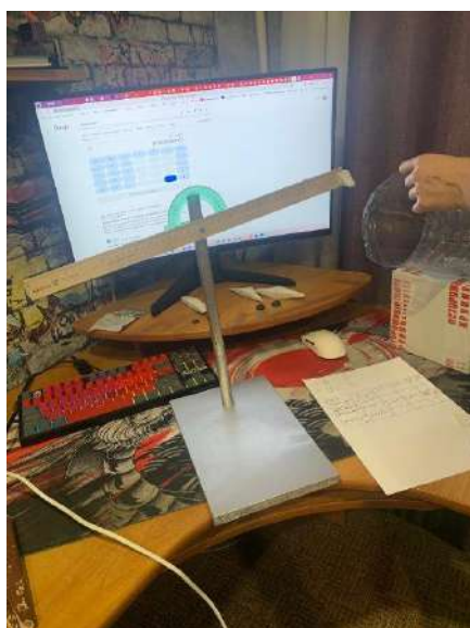
Приложение 3 (прибор для измерения подъёмной силы и лобового сопротивления с крылом собственной формы)
