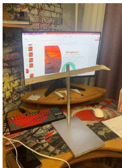
Приложение 4 (прибор для измерения подъёмной силы и лобового сопротивления с крылом эллипсоидной формы)
