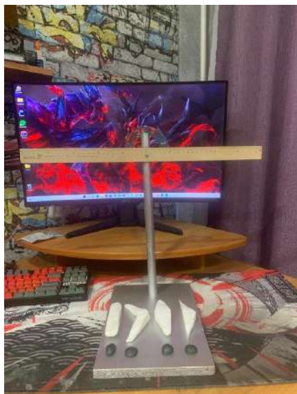
Приложение 1 (прибор для измерения подъёмной силы и лобового сопротивления крыла со всеми составляющими)
