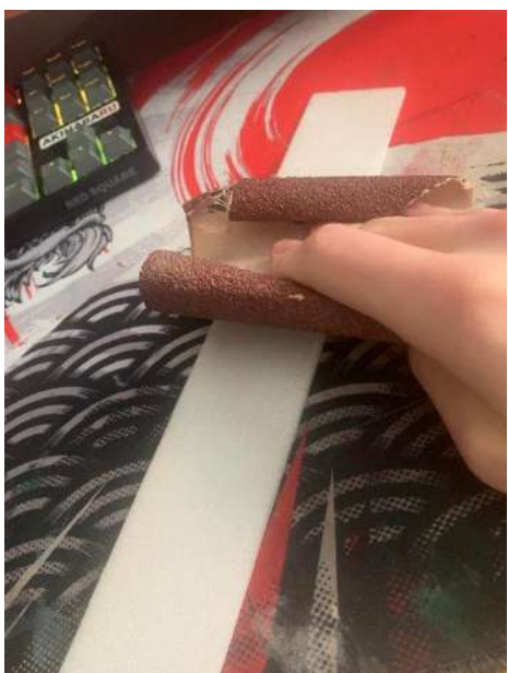
Приложение 11 (зачистка поверхности детали для лучшего прилегания)
