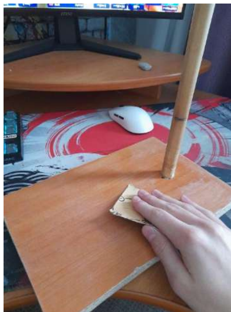
Приложение 12 (шлифовка поверхности для лучшего сцепления с краской)
