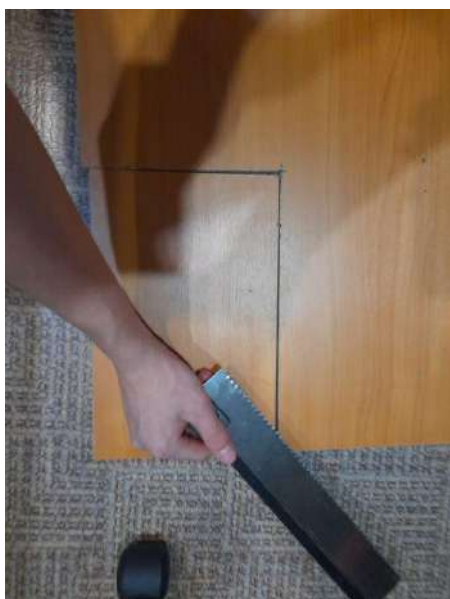
Приложение 7 (вырезание детали из куска ДСП для прибора)
